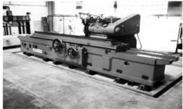
شکل ۱۰- فاصله بین لرزه گیرها کم و تعداد آنها زیاد است و نامتقارن نصب شده اند.
